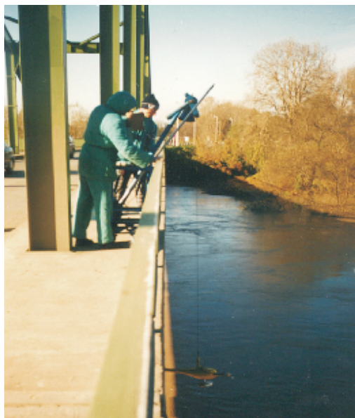
Vízhozammérés 1998. november 7-én a Tiszán Vásárosnaménynál 923 cm-es vízállásnál
