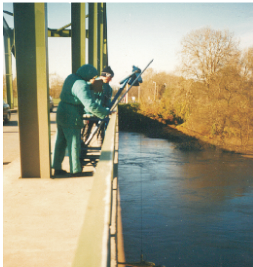
Виміри витрат води 7 листопада 1998 р. при рівні води 925 см на р.Тиса біля Вашарошнемін
